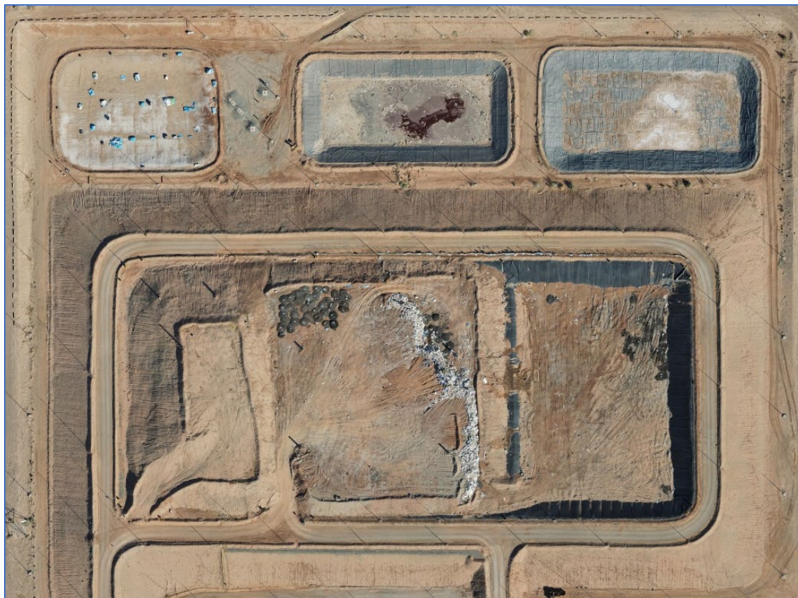
Зураг 14. Хог хаягдал булшлах 3 үүр, аюултай хог хаягдлын ландфилл болон шүүрсэн усыг ууршуулах цөөрөм
