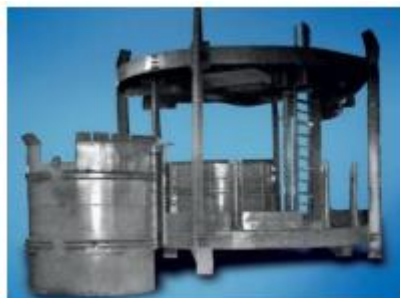
Зураг 2. Босоо ам нэвтрэлтийн үеийн нэвтрэлтийн тавцан Тус ордын босоо амуудын бүтээн байгуулалтын ажлыг 2011-2013 онд гүйцэтгэсэн.
