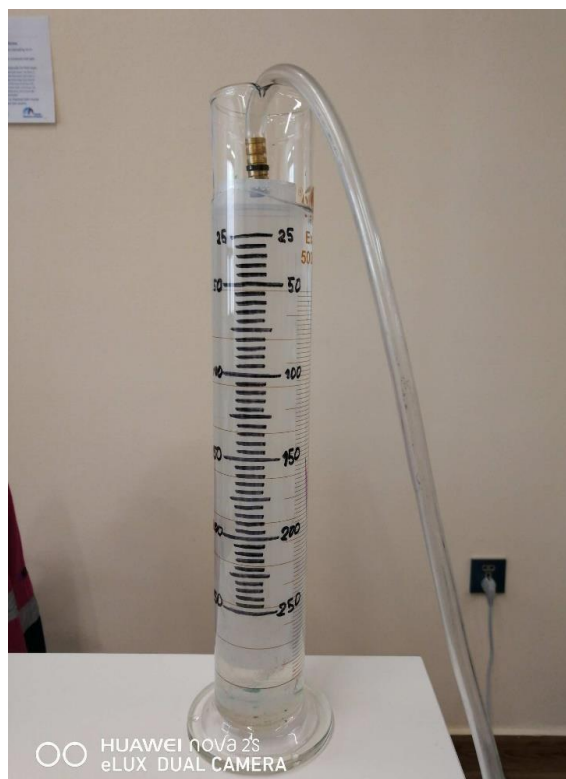
Зураг 7. Нүүрсний хийн эзлэхүүн хэмжигч 250 мл-ийн цилиндр болон агуулагч шилэн цилиндрээс бүрдсэн багаж
