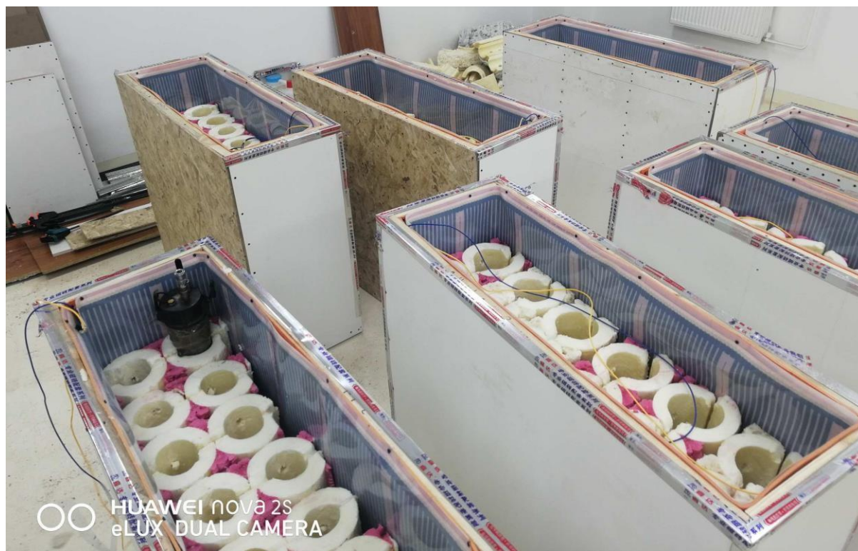
Зураг 6. “Тэлмэн Ресурс” ХХК-ийн угсарсан лабораторын зориулалттай ашиглах тус бүр нь 14 ш бортого агуулах хүчин чадалтай хөөсөн ванн
