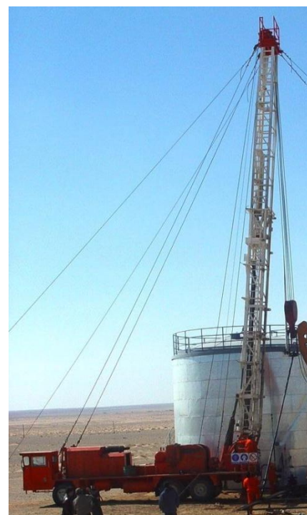
Зураг. Дээд талд: шингэн хагалбарын цогц төхөөрөмж, зүүн талд: цооногийн туршилт үйлчилгээний цамхагт төхөөрөмж
