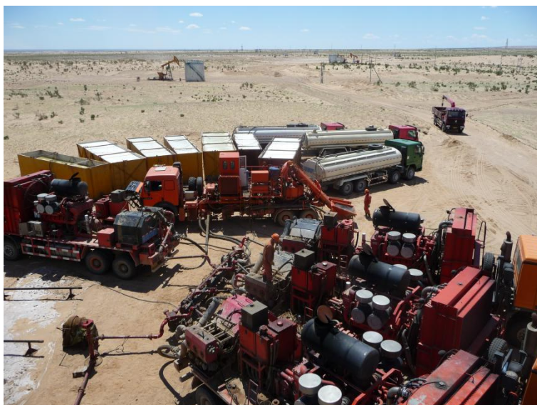
Зураг. Дээд талд: шингэн хагалбарын цогц төхөөрөмж, зүүн талд: цооногийн туршилт үйлчилгээний цамхагт төхөөрөмж
