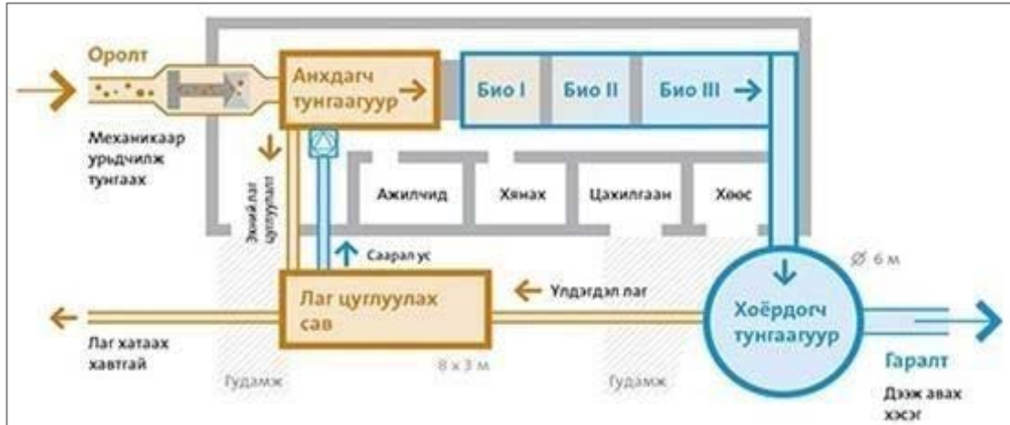
Зураг 6. WSB цэвэрлэгээ бүхий ус цэвэрлэх байгууламжийн технологийн схем
