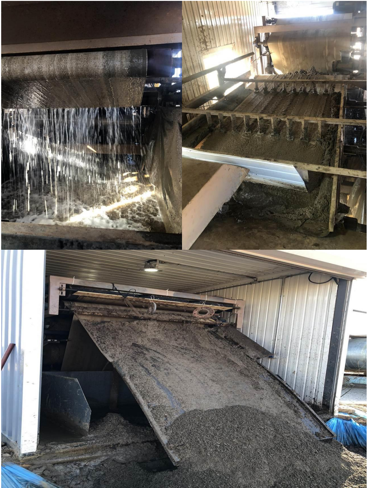
Зураг 4. Угаасан шороог усгүйжүүлэх тоног төхөөрөмж
