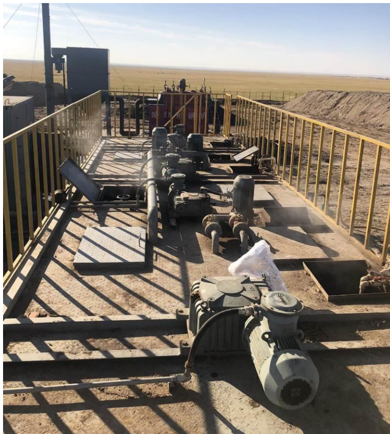
Зураг 3. Тосоор бохирдсон шороог угааж цэвэршүүлэх тоног төхөөрөмж
