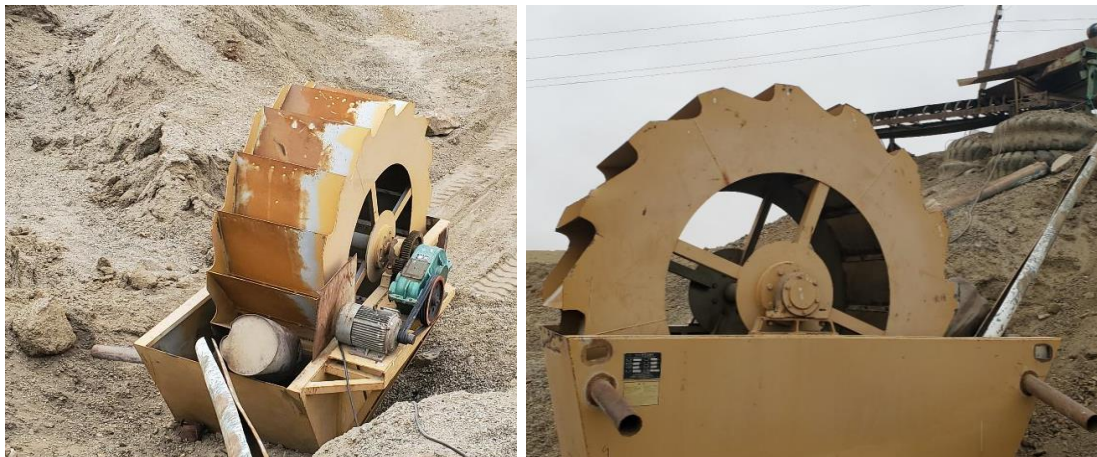
Зураг 2-6. Тус үйлдвэрт ашиглаж байгаа XSD2610 элс угаагч
