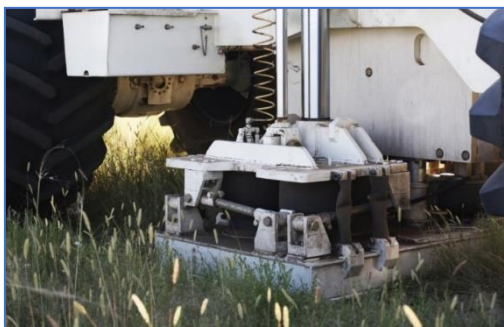
Зураг 1. 4. Вибраторийн машин уян харимхай долгион үүсгэж буй нь
