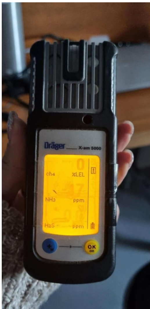
Зураг. 1 Химийн бодис хадгалж буй тасалгаанд Dräger X-am 5000 хорт хий хэмжигч багажаар хэмжилт хийж буй нь
