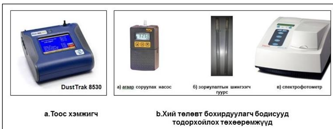
Зураг 94. Агаарын чанарын хэмжилт хийсэн багаж, тоног төхөөрөмжүүд
