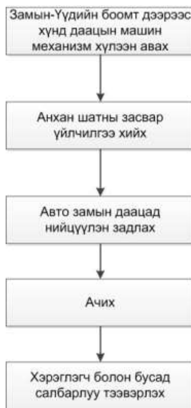
Зураг 1. Хүнд машин механизмын тэвш угсрах цехийн технологийн схем
