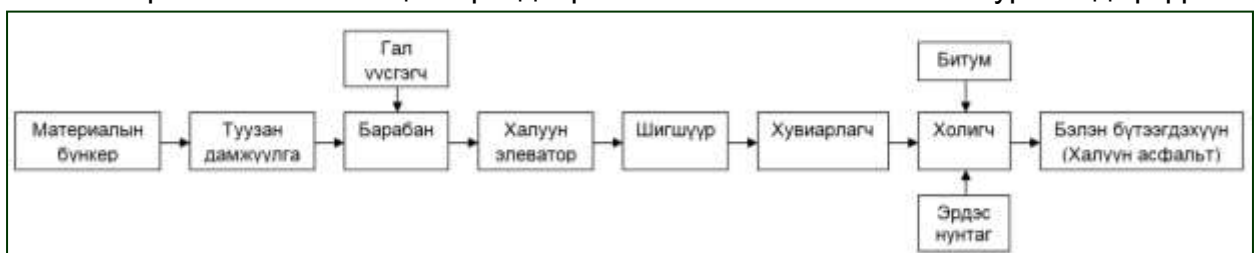
Зураг 7. Үйлдвэрийн технологийн схем
