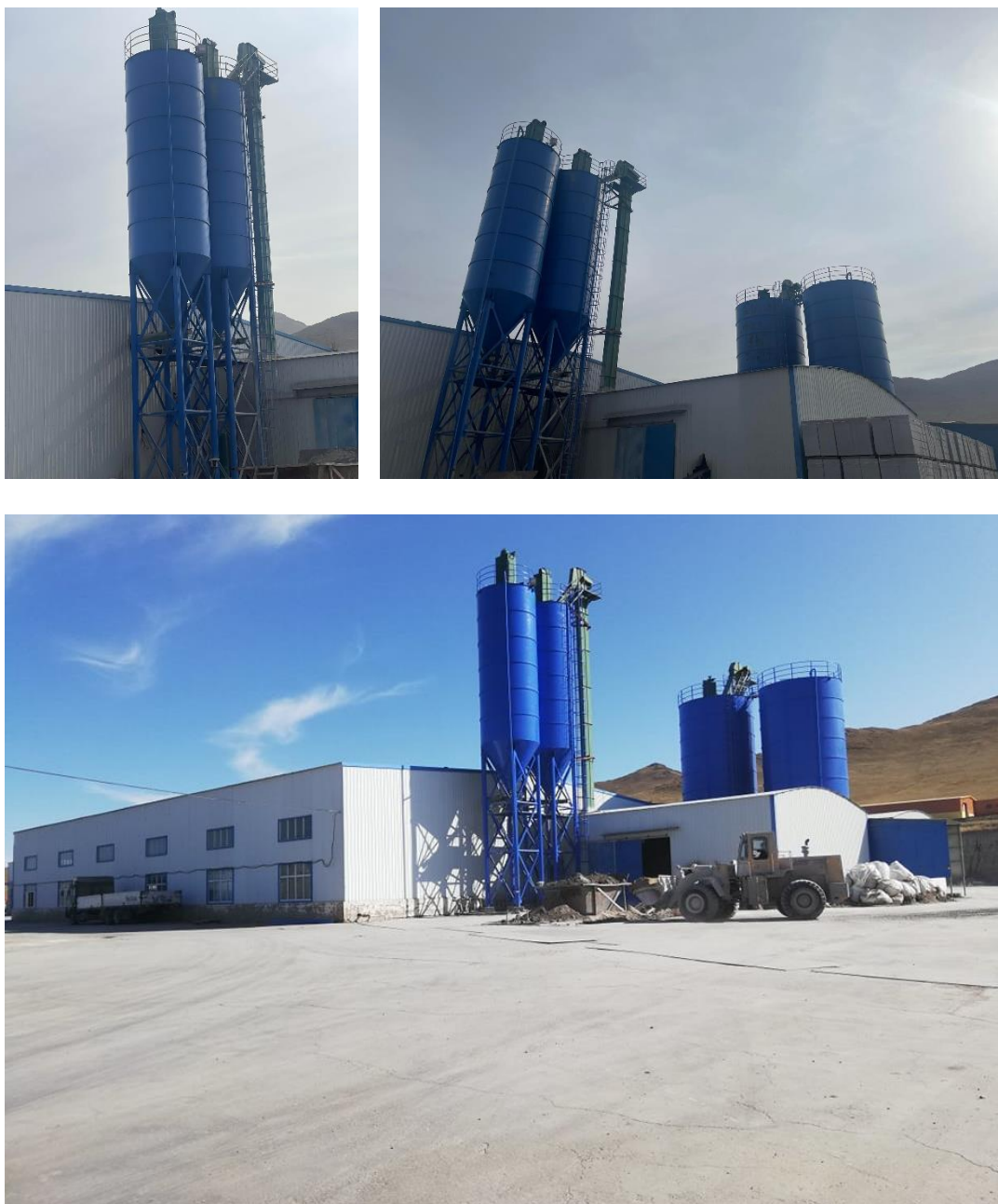
Зураг 5. Цемент, шохой зэрэг түүхий эдийг үйлдвэрийн битүү силост хадгалдаг байдал
