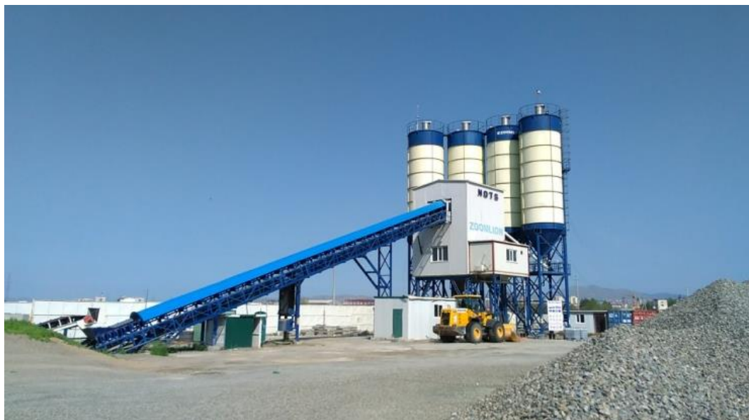
Зураг 2. Бетон зуурмагийн үйлдвэрийн суурин тоног төхөөрөмж
