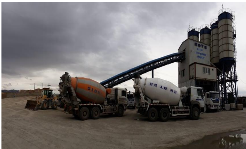
Зураг 10. Бэлэн болсон бетон зуурмагийг зориулалтын холигч тээврийн хэрэгсэлд юүлж буй байдал
