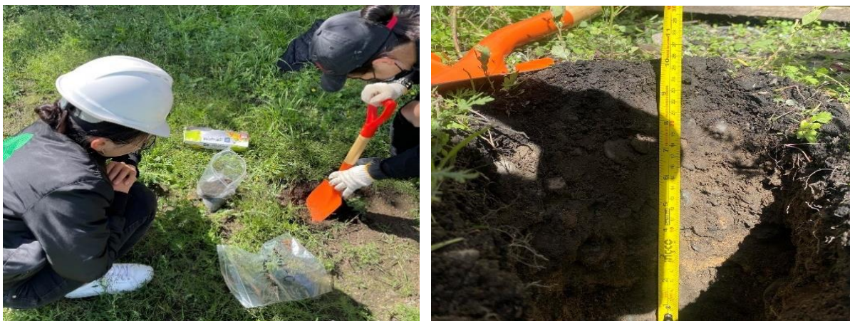
Зураг 2-17. Хөрсний дээжлэлт хийж буй үйл явц
