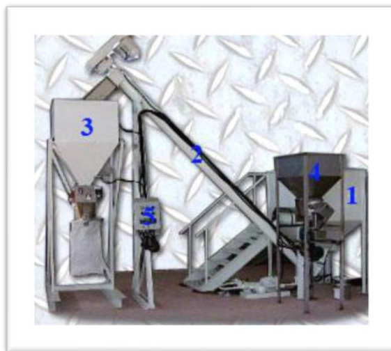
Зураг 7. Энгийн тэсрэх бодис үйлдвэрлэх суурин тоног төхөөрөмжийн схем
