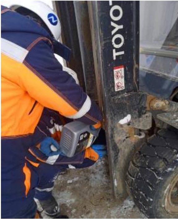
Зураг 41 Зэвсэгт хүчний нэгдсэн лабораториор үйлдвэр, агуулахын газардуулга болон аянга зайлуулагчийн эсэргүүцлийг хэмжүүлсэн
