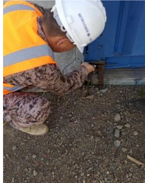
Зураг 41 Зэвсэгт хүчний нэгдсэн лабораториор үйлдвэр, агуулахын газардуулга болон аянга зайлуулагчийн эсэргүүцлийг хэмжүүлсэн
