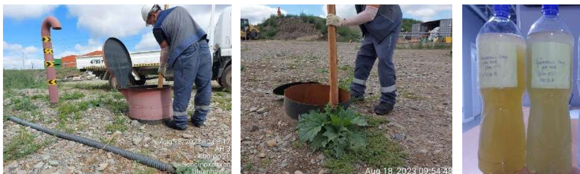
Зураг 9-18: Бохир усны чанарын хяналт шинжилгээний дээж авч буй байдал, 2023.08.18
