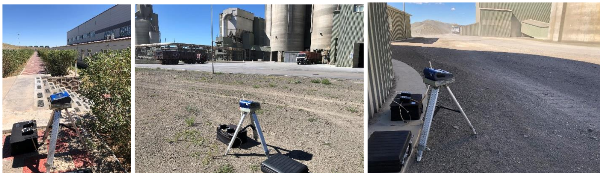
Зураг 42. Үйлдвэрийн талбайн агаар, тоосны хэмжилт
