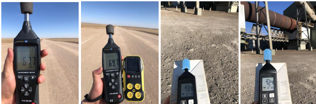
Зураг 44. Дуу шуугианы хэмжилт хийж буй байдал
