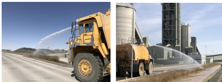
Зураг 4. Зам талбайн усалгаа хийж буй байдал
