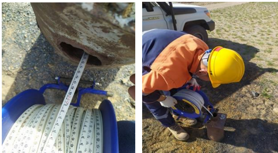
Зураг 39. Үйлдвэрийн ашиглалтын худгуудад хэмжилт хийж буй байдал
