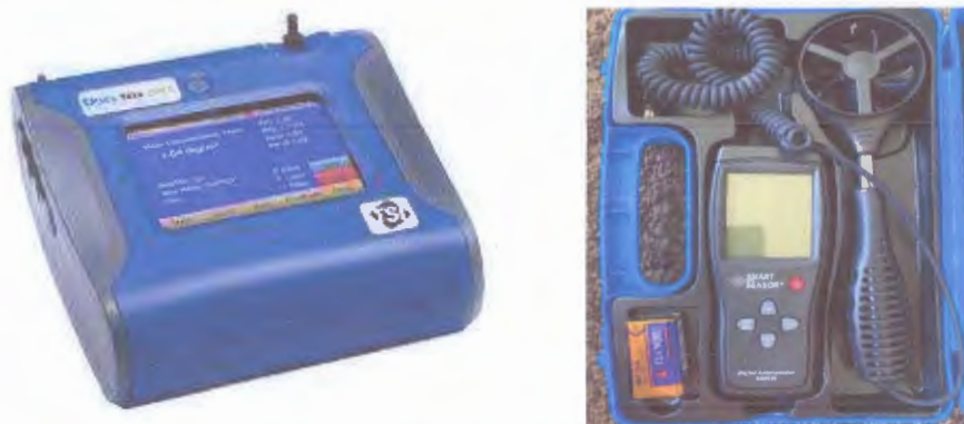
Зураг 7.1. Тоосны хэмжилтын багаж Dustrak 8533
