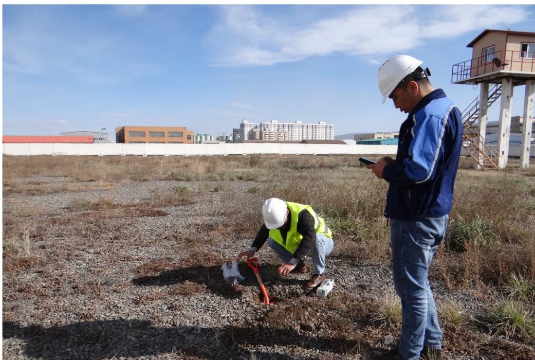
Зураг 15. Талбайн хөрсний дээжлэлтийн зураг
