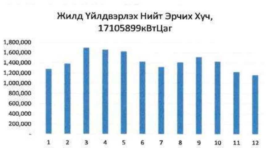
Зураг 12. 10МВт Polycrystalline нарны цахилгаан станцын жилд үйлдвэрлэх нийт эрчим хүчний хэмжээ
