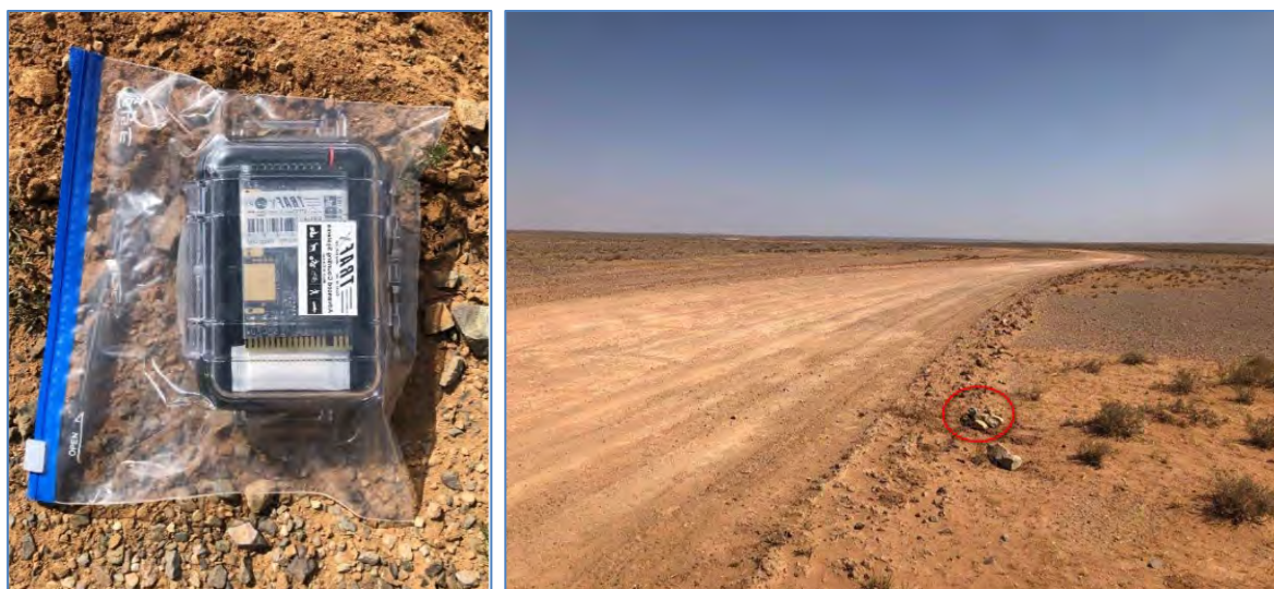
Зураг 9-35. Замуудад байршуулж буй тээврийн хэрэгсэл тоологч багаж
