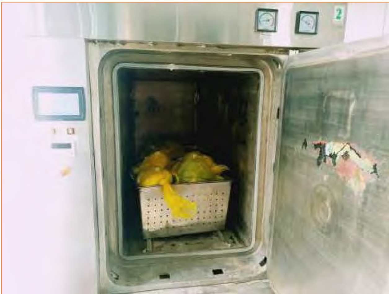
Зураг 8-27. Эмнэлгийн хаягдлыг автоклаваар ариутгаж буй байдал
