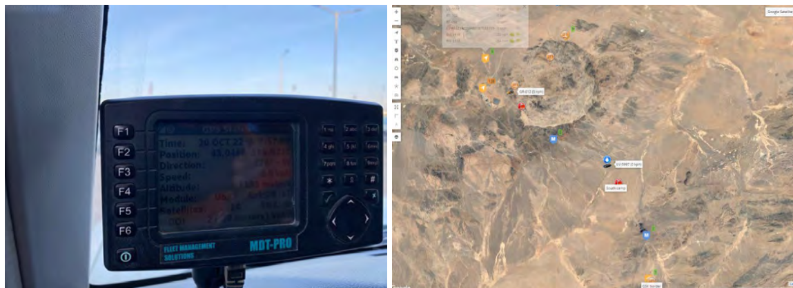
Зураг 2-5. Тээврийн хэрэгсэлд байршуулсан GPS-ийн дэлгэц (зүүн), хяналтын өрөөнд байрлах тээврийн хэрэгслийн байршил, хурдны хяналтын дэлгэцний харагдах байдал (баруун)
