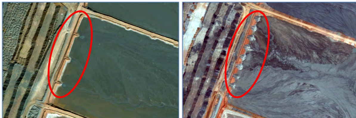
Зураг 2-26. Цөөн хоолойгоор хаягдал хаядаг байсныг олон хоолойгоор хаядаг болгосон байдал (Сансрын зураг)
