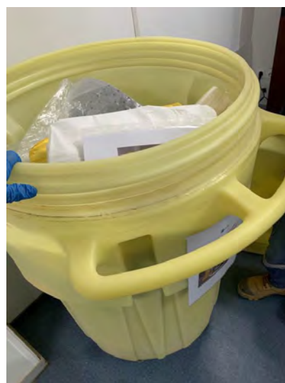
Зураг 7-6. Бохир ус цэвэрлэх байгууламж, асгаралтын үед ашиглах шингээгч материал
