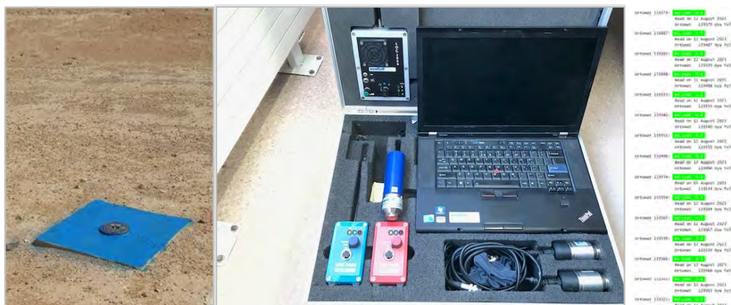
Зураг 2-24. Түүхий усны шугамын алдагдал шалгах багаж суулгасан байдал болон мэдээлэл татах багаж
