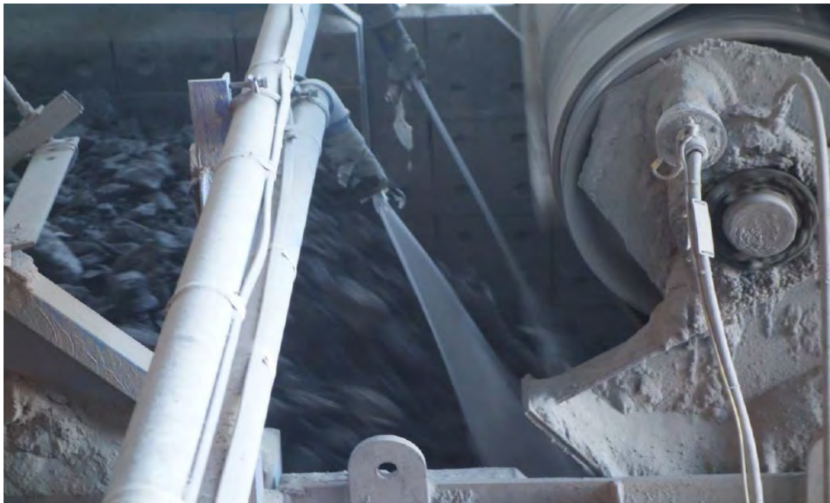
Зураг 2-7. Анхдагч бутлуураас гарч буй хүдэрт тоос дарагч бодис цацаж буй байдал
