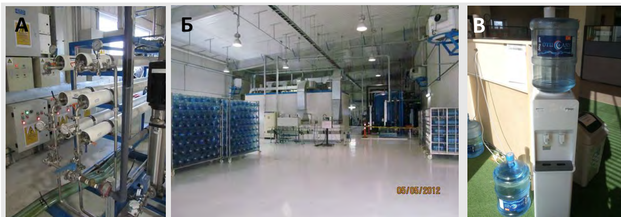
Зураг 2-38. УЦСҮ-ийн урвуу осмосын nano шүүлтүүр, Б. УЦСҮ-ийн цэвэршүүлэх хэсэг, В. 18,9 литр савласан ус
