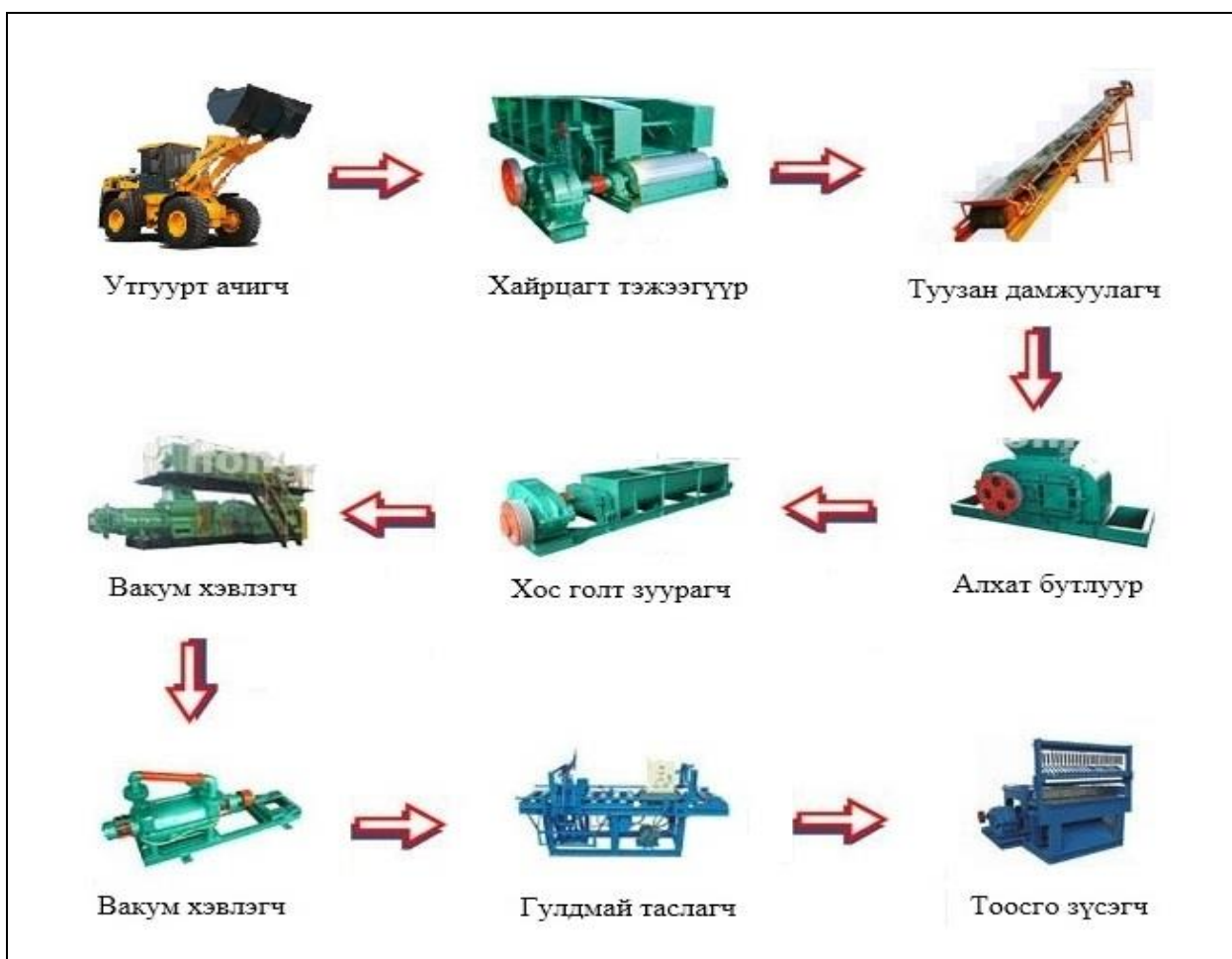
Зураг 1.3. Тоосго үйлдвэрлэлийн тоног төхөөрөмжийн дамжлага схем
