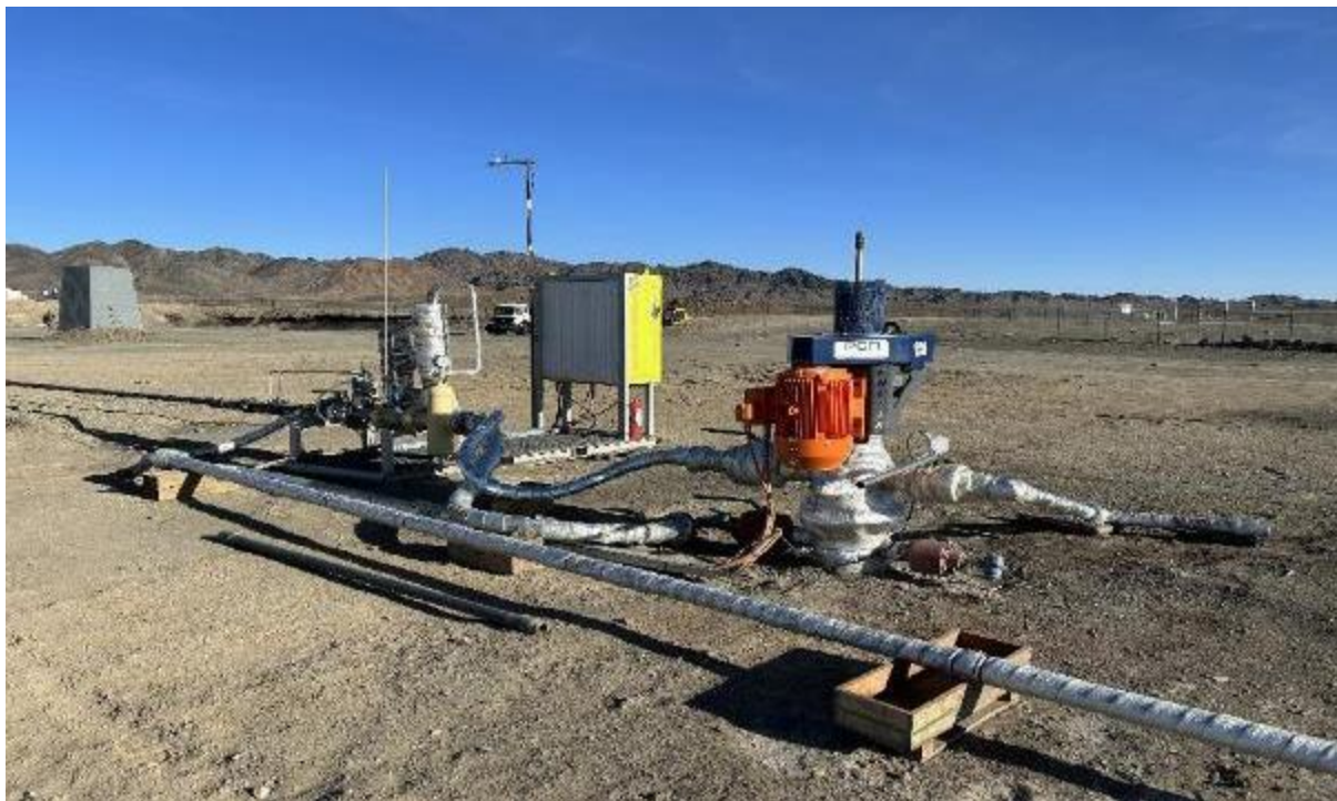
Зураг 8. Номгон-10 цооногт туршилтын журмаар шавхалт хийж буй байдал
