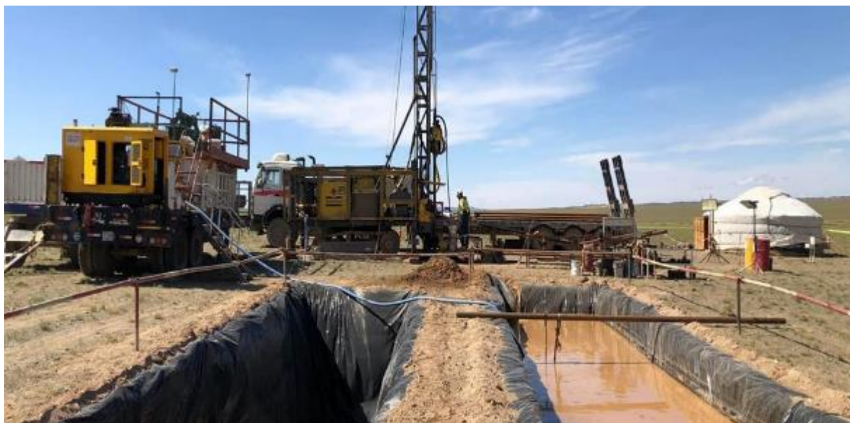
Зураг 62. Өрмийн шингэн хаягдлыг тусгай санд хуримтлуулан байдал
