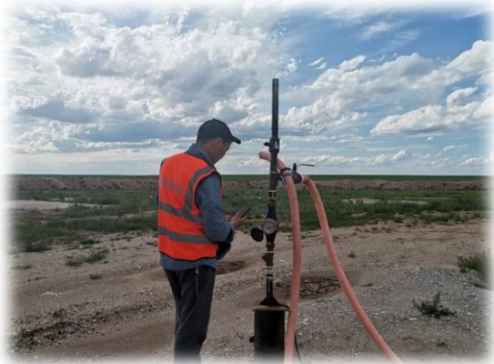
2023.08.26-ны уурхайн шүүрлийн усны тоолуур баталгаажуулалт
