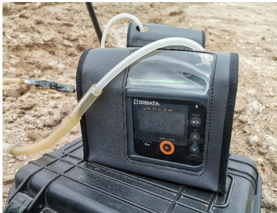
Агаар дахь хүхэрлэг хий /SO 2 /, азотын давхар исэл /NO 2 /-ийг тодорхойлогч багаж
