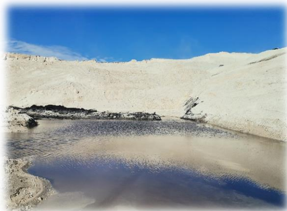
Зураг 11. Уурхайн шүүрлийн усыг тусгай зумп байгуулж хуримтлуулан ашигласан байдал
