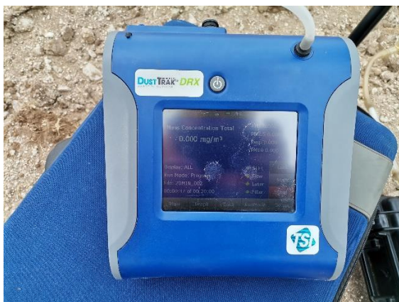
Агаарын нийт тоосонцор хэмжих DUST TRAK DRX 8530
