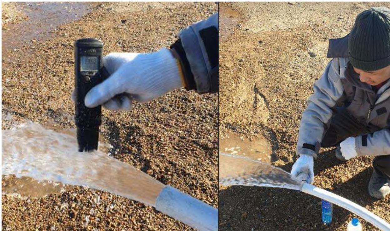
Зураг 7. Шавхалтын явцад сорьц авч буй байдал болон хээрийн хэмжилт судалгаа. /PH, TDS, EC, T°C/
