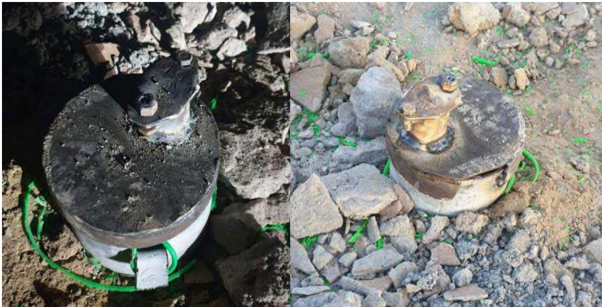
Зураг 3. М-1, М-2-Мониторингийн цооногийн ашиглалтад бэлтгэсэн байдал.
