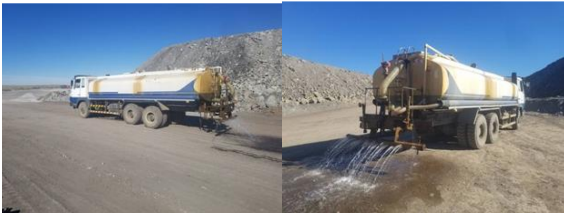
Зураг №3 Уурхайн дотоод зам усалгаа хийж буй зураг
