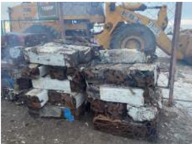
Зураг-56. Төмрийн хаягдлын овор хэмжээг нягтруулсан байдал
