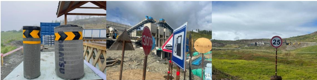
Зураг- 30 Зүүн талаас хаягдал агаар шүүгч, тэмдэглэгээ болгон ашиглан, хаягдал төмөр, листээр тэмдэг тэмдэглэгээ хийж, хаягдал обудыг тэмдэг тэмдэглэгээний суурь болгон ашигласан нь
