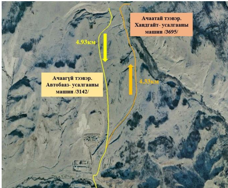
Зураг- 2 Туршилт хийгдсэн зам, талбай. Хандгайтын усалгааны машин Хандгайт голоос, Автобазын усалгааны машин Булгийн голоос тус тус ус соруулна.
