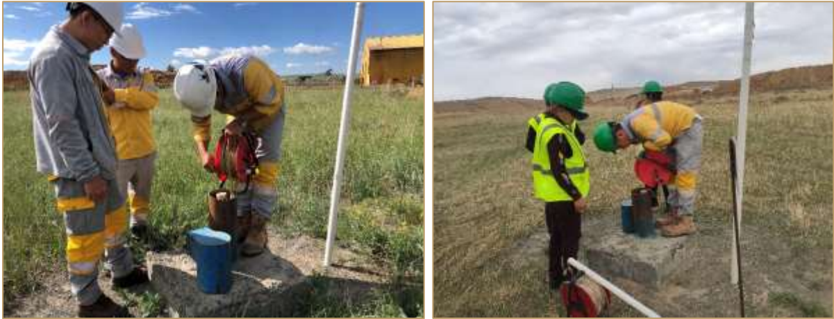
Зураг 36. НУ-ын хяналтын цооногуудын гүний усны түвшин хэмжилт
