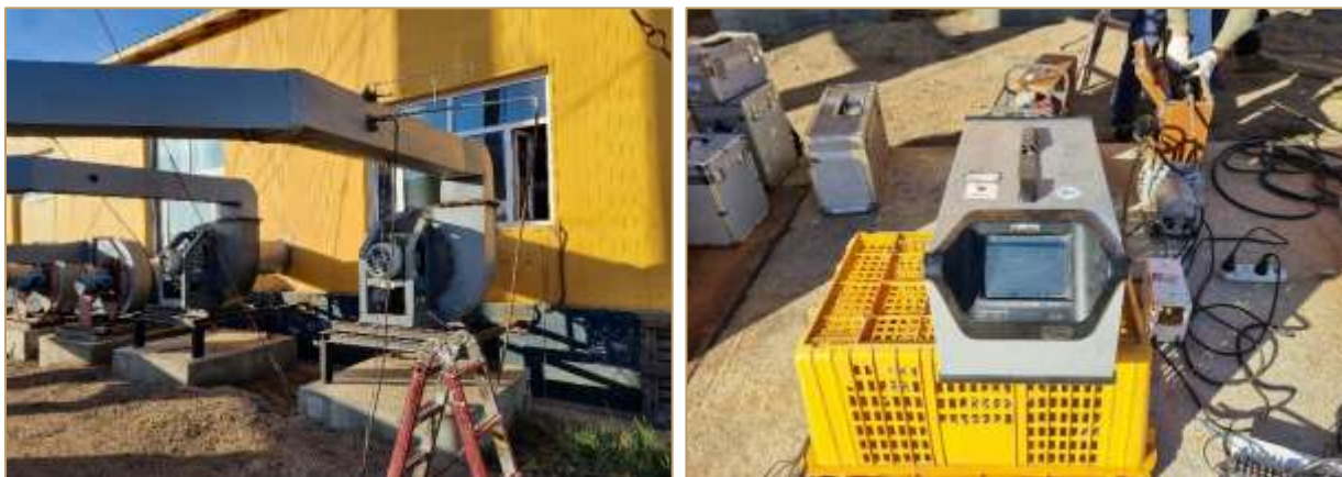
Зураг 11. Усан халаалтын зуухны утааны хэмжилт, дээжлэлт
