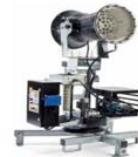
Төрөл SPRAYSTREAM single CART 25i Зай 25 М Даралт 20-100 BAR Зарцуулалт 900-400 L/H
