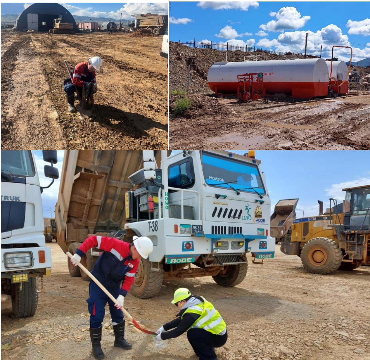
Зураг 19 Засварын талбай, нөхөн сэргээлт болон ШТС-ийн орчмоос хөрсний дээж авч буй байдал
