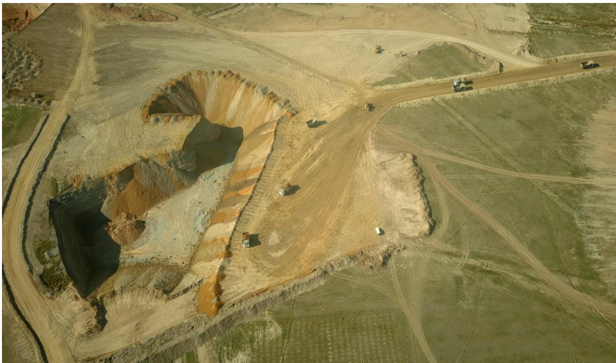
Зураг 23 Дотоод овоолго үүсгэх замаар нөхөн сэргээлтийн ажил хийгдэж буй байдал
