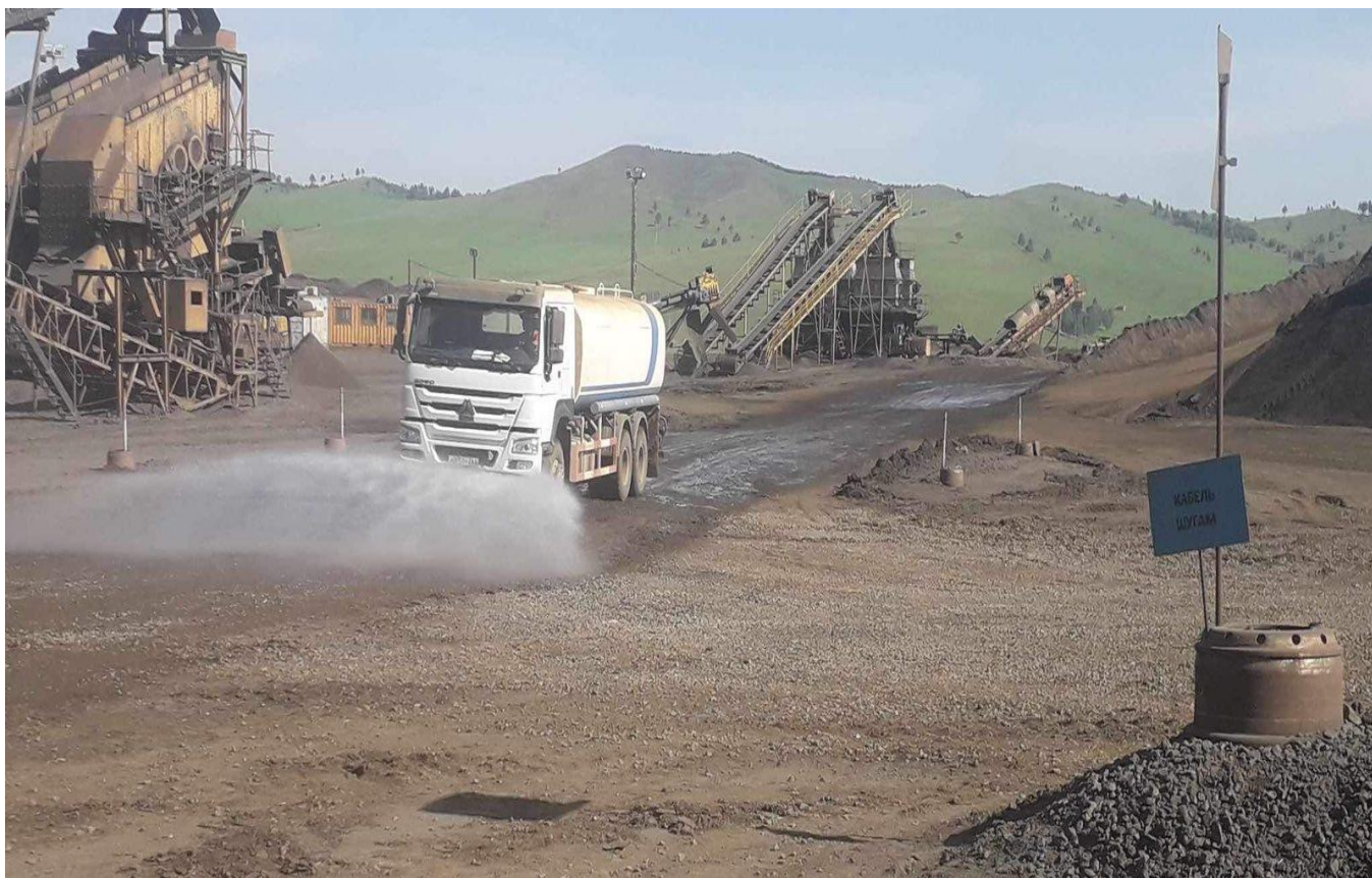
Зураг 1 Уурхайн зам дээр усалгаа хийж байгаа байдал
