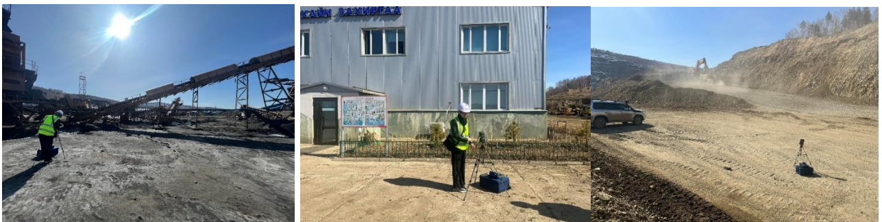
Зураг 58 Агаарын шинжилгээний дээж авч буй байдал
