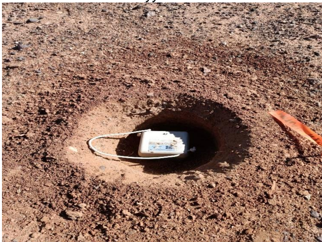
Смарт соло багажийг газарт суурилуулан мэдээлэл хүлээн авч байгаа байдал
