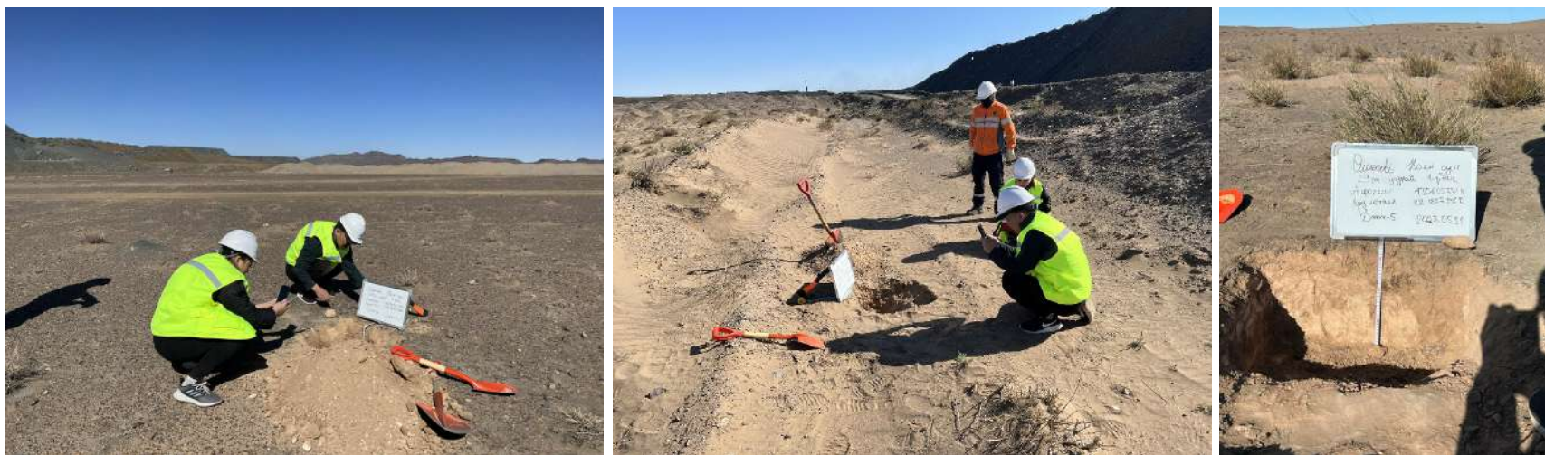
Зураг 60. Гео Инженер Сүрвэй ХХК-ийн ажилчид газрын төлөв байдал чанарын хянан баталгаа хийхээр хөрснөөс хүнд металл болон агрохимийн дээж авч буй байдал
