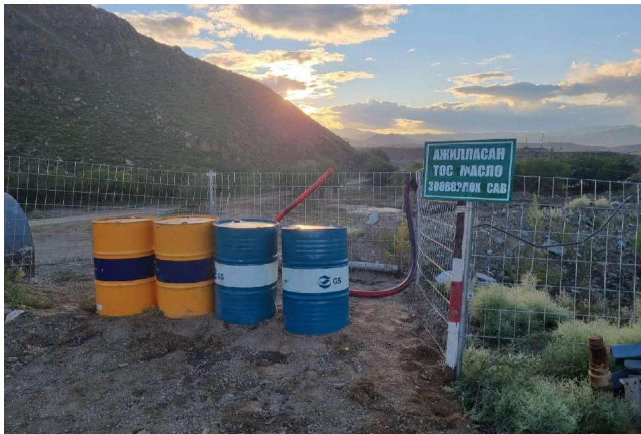
Зураг 6. ШТМ-ыг уурхайн талбайд тусгай зориулалтын саванд хадгалж таних тэмдгийг байршуулсан байдал
