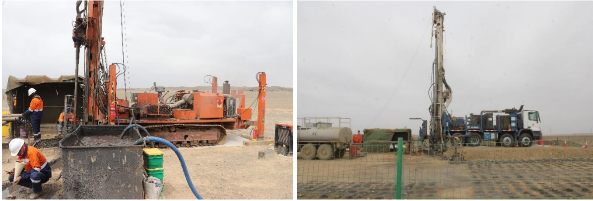
Зураг 4. Стратиграфийн цооногийн болон туршилтын босоо цооногийн өрөмдлөгийн ажилд ашигласан өрмийн машинууд
