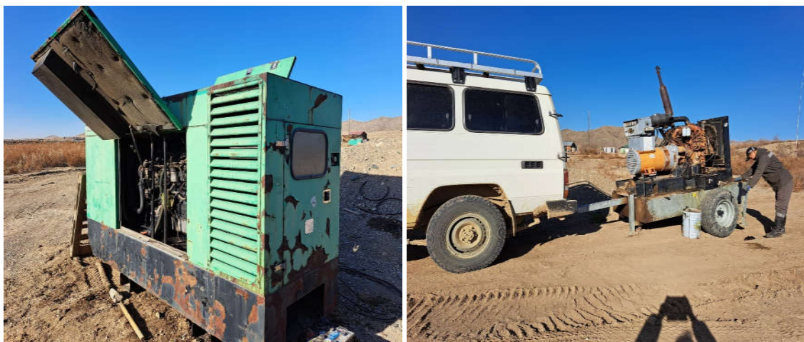
Зураг: Уурхайг цахилгаанаар хангаж буй дизель генератор
