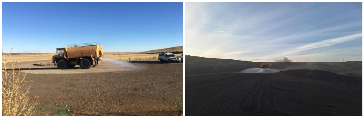
Зураг 3. Уурхайн технологийн замыг усны Белаз усалж замын тоосыг дарж байгаа нь.
