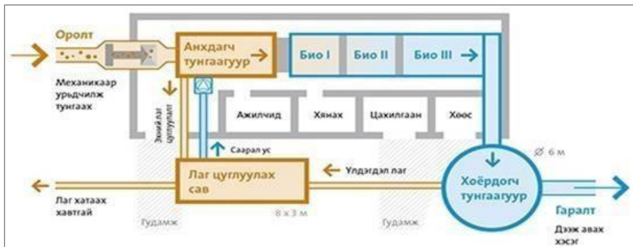
Зураг 4. WSB цэвэрлэгээ бүхий ус цэвэрлэх байгууламжийн технологийн схем
