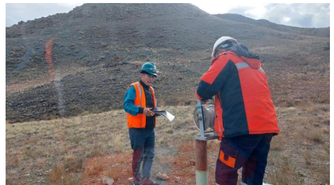
Хяналтын цооногуудад түвшний хэмжилт хийж буй байдал
