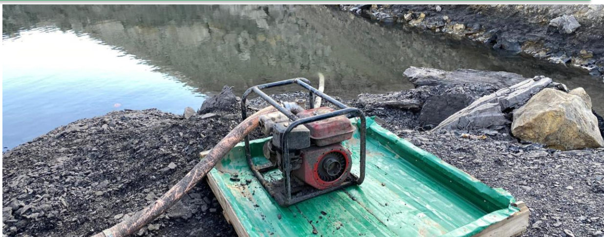
Зураг 14. Усны насосны битүүмжлэлтэй хашилага бүхий суурь
