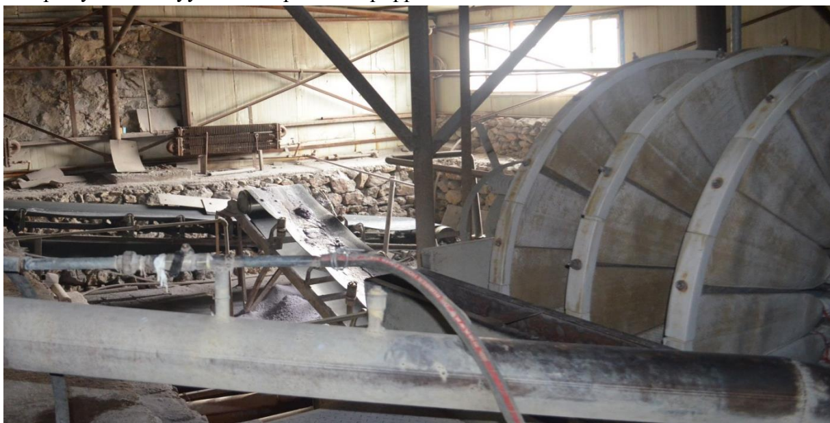
Зураг 5. Баяжуулах үйлдвэрийн баяжмал усгүйжүүлэх хэсгийн фото зураг Баяжмал хатаах хэсэг
