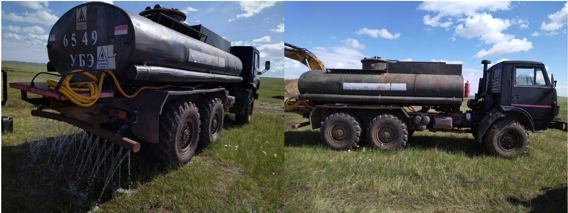
Зураг 12. Агаарын чанарт үзүүлэх сөрөг нөлөөллийг бууруулах арга хэмжээний төлөвлөгөөний 2-р заалтын биелэлт Уурхайн замын тоосжилтыг дарах зорилгоор дээрх зурагт харуулж буй техникийг ашиглаж байгаа бөгөөд тухайн усалгааны машиныг зөвхөн бороо ороогүй үед болон бороо орсноос 2 хоногийн дараагаар ашиглаж хэвшсэн болно.
