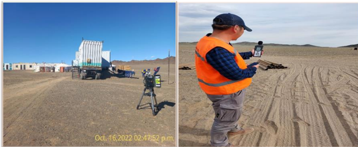
Зураг 39. Агаарын сорьц болон дуу шуугианы хэмжилт хийж буй байдал
