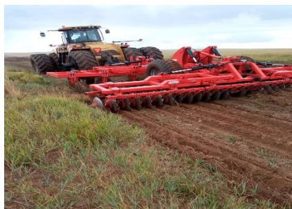
Зураг № 20. Ашиглагдахгүй болсон замыг хагалж сийрүүлж, буталж байгаа байдал
