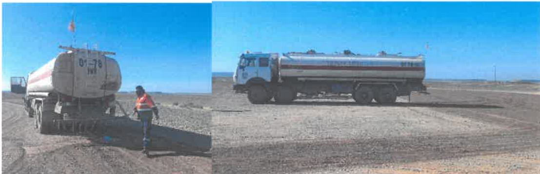
Зураг 21. Усны машинд ус цацруулагч хоолой суурьлуулсан
