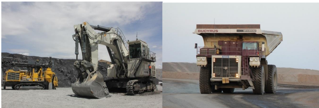
Зураг 5. PV275 Тээлгээний өрөм, Экскаватор, МТ 4400 хүнд даацын машин
