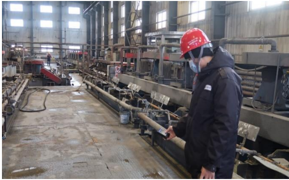
Зураг 9.4д. Ажиглалтын бүс баяжуулах үйлдвэр тээрэмийн ташин гамма цацрагийн тунгийн чадалын хэмжилт
