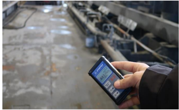
Зураг 9.4д. Ажиглалтын бүс баяжуулах үйлдвэр тээрэмийн ташин гамма цацрагийн тунгийн чадалын хэмжилт
